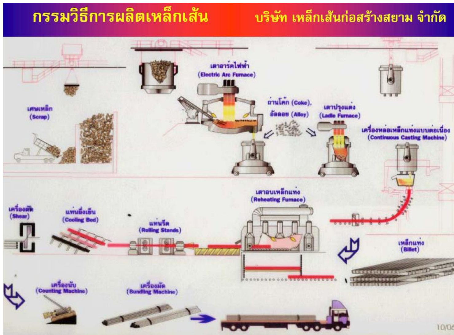
รูปที่ 2-5 แผนผังแสดงกรรมวิธีการผลิตเหล็กเส้น ของบริษัท ทาฮา สตีล การผลิต (ประเทศไทย) จำกัด (มหาชน) (บริษัท เหล็กก่อสร้างสยาม จำกัด (เดิม))
