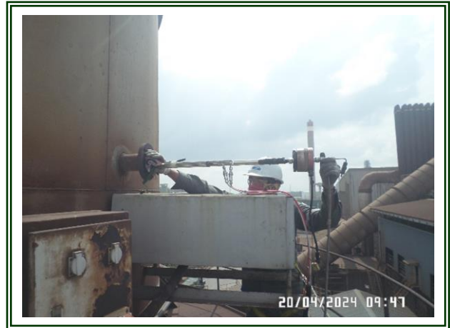
รูปที่ 4-44 ตรวจวัดปล่องที่ผ่านโรงกำจัดฝุ่น (Fume Plant # 1) ตรวจวัดในวันที่ 20 เมษายน 2567
